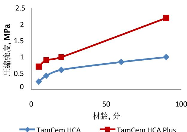
上のグラフは吹付けコンクリートの初期材齢における圧縮強度を示しています。TamCem HCA Plusを使用した場合の方が優れた強度発現を示しています。
